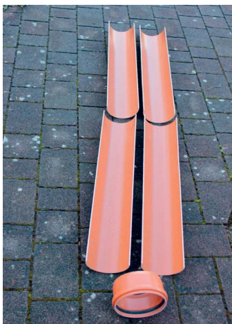
Рис. 1-2. Водопроводная ПВХ-труба и то, что должно из нее получиться, — 8 лопастей одного размера и веса.
