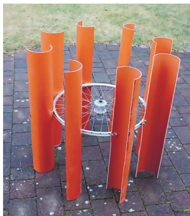
Рис. 3-4. Каждая лопасть крепится двумя винтами к ободу колеса. Ротор динамо-машины крепится непосредственно на втулку колеса.
